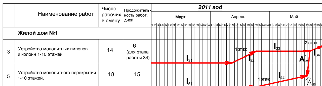
Рис. 5. Представление потоков «устройство монолитного перекрытия цокольного этажа», «устройство монолитных пилонов и колонн 1-10 этажа» и «устройство монолитного 1-10 этажей» в векторной форме без частичного совмещения этапов работ.
