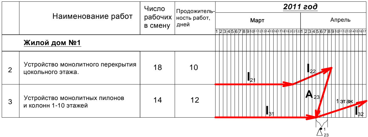
Рис. 4. Представление потоков «устройство монолитного перекрытия цокольного этажа» и «устройство монолитных пилонов и колонн 1-10 этажа» в векторной форме с частичным совмещением этапов работ.
