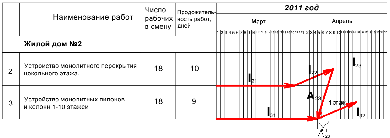
Рис. 4. Представление потоков «устройство монолитного перекрытия цокольного этажа» и «устройство монолитных пилонов и колонн 1-10 этажа» в векторной форме с частичным совмещением этапов работ.
