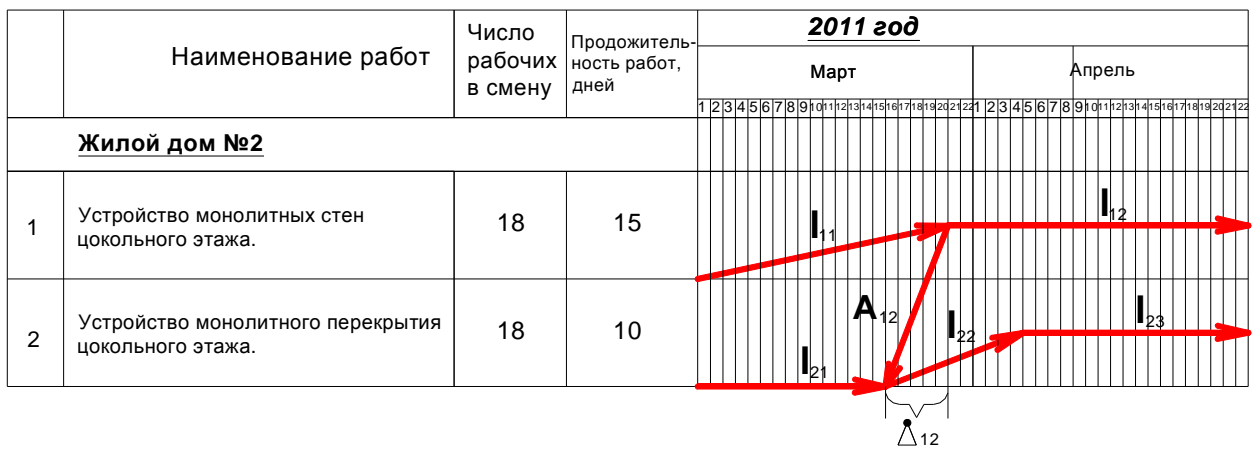
Рис. 2. Представление потоков «устройство монолитного перекрытия цокольного этажа» и «устройство монолитных стен цокольного этажа» в векторной форме с частичным совмещением этапов работ.
