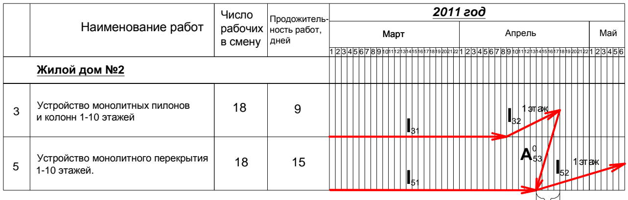
Рис. 8. Представление потоков «устройство монолитного перекрытия цокольного этажа» и «устройство монолитных пилонов и колонн 1-10 этажа» в векторной форме с частичным совмещением этапов работ.
