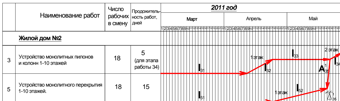
Рис. .6. Представление потоков «устройство монолитного перекрытия цокольного этажа» и «устройство монолитных пилонов и колонн 1-10 этажа» в векторной форме с частичным совмещением этапов работ.
